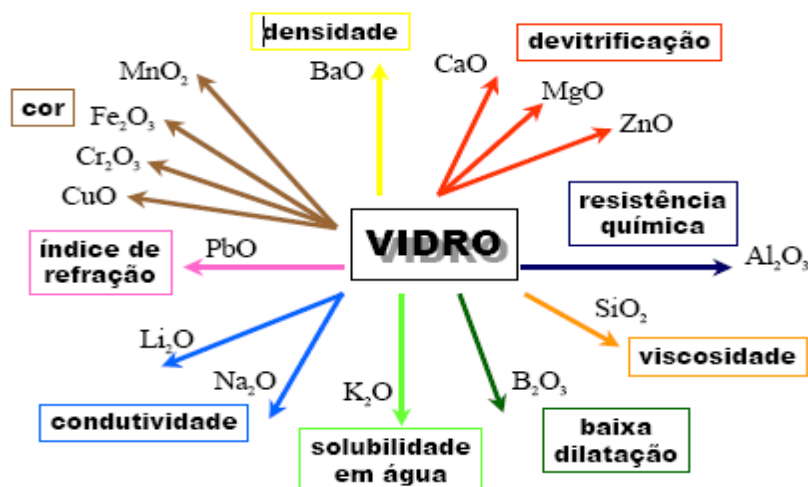
Figura 2.9 - Funções relativas dos óxidos no vidro
