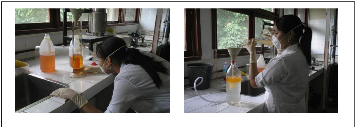
FIGURA 10 - Etapas para preparação da dispersão gasolina/ água.
