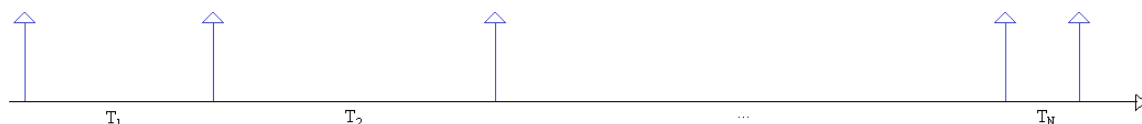
Figura 4.13: Exemplo de saída do gerador de trem de impulsos, C(t) , com espaçamento cicloestacionário obtidos a partir do vetor T_N .
