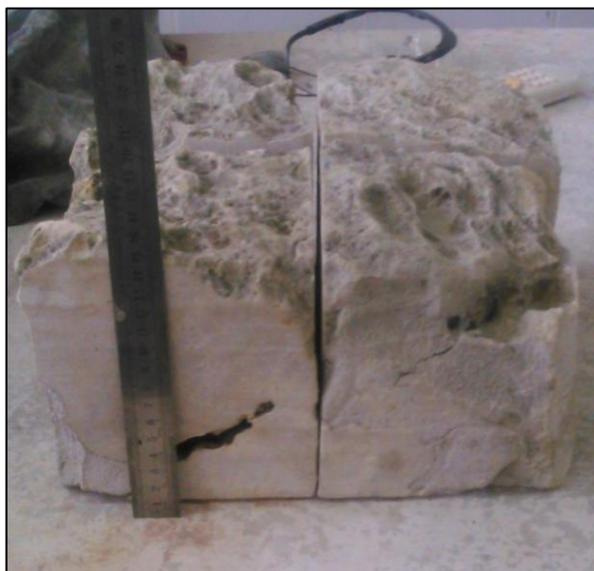
Figura 3.6 – Amostra de tufa carbonática dos quatro blocos do topo, mostrando as porosidades vugular e fratural.
