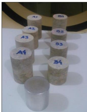
Figura 3.11 – Plugues iniciando o escaneamento, juntamente com plugue de alumínio.
