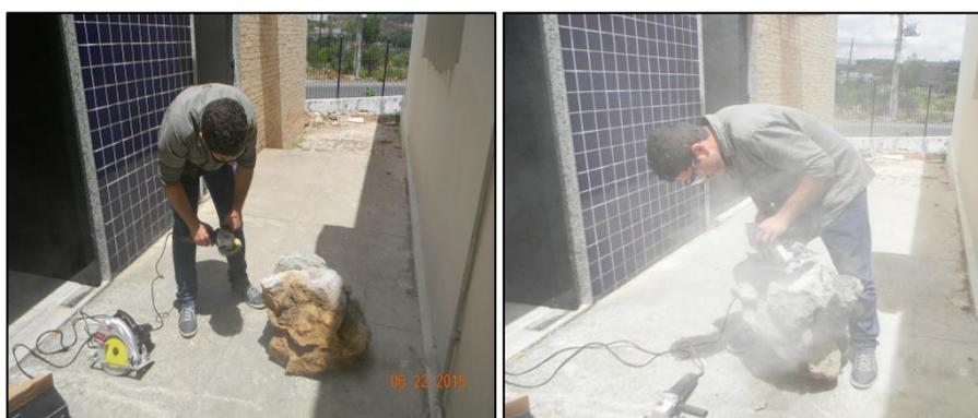
Figura 3.4 – Amostra de tufa carbonática sendo trabalhada para torná-la com dimensões próximas a um cubo, localidade Cachoeira do Roncador.
