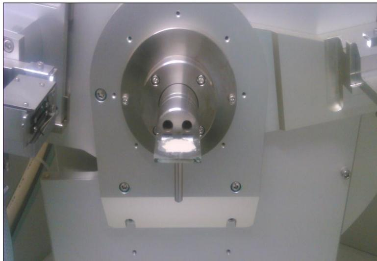
Figura 3.16– Amostra de tufa carbonática sendo analisada pelo equipamento de Difração de Raios X da UFCG, modelo SHIMADZU – XRD 7000.
