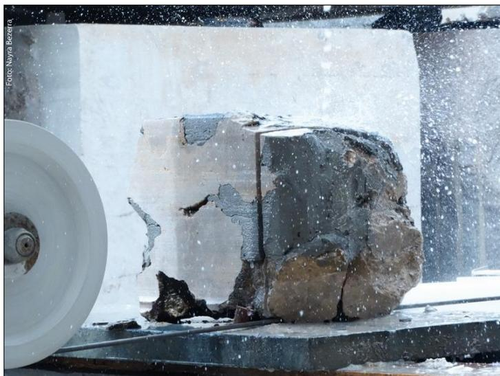
Figura 3.8 – Corte da amostra de tufa carbonática tornando-a em cubo. Foto cedida pela Granfuji.
