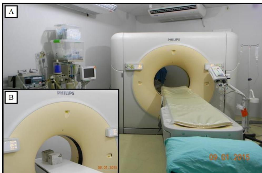
Figura 3.12 – (A) Tomógrafo médico utilizado nesta pesquisa. (B) Detalhe de duas amostras de tufa carbonática sendo escaneadas
