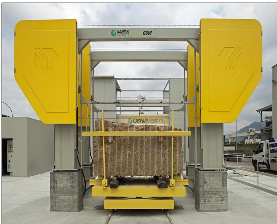
Figura 3.7 - Máquina de corte monofio. Gaspari Menotti. Disponível em:
