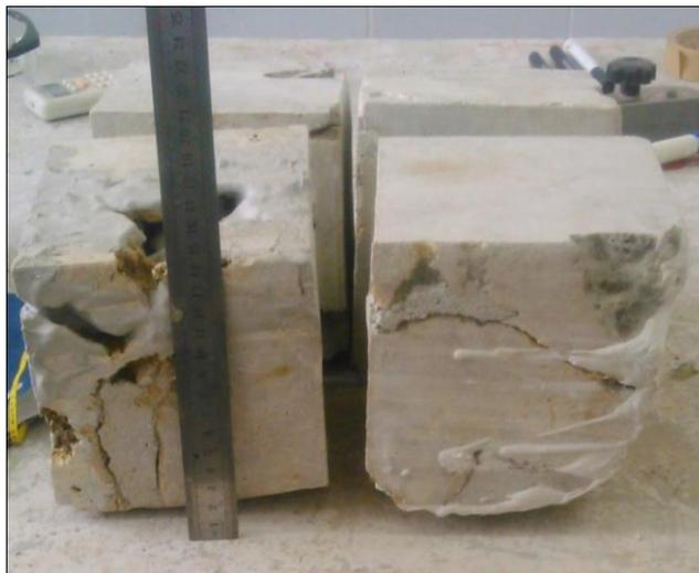
Figura 3.5 – Amostra de tufa carbonática dos quatro blocos da base, mostrando as porosidades vugular e fratural.
