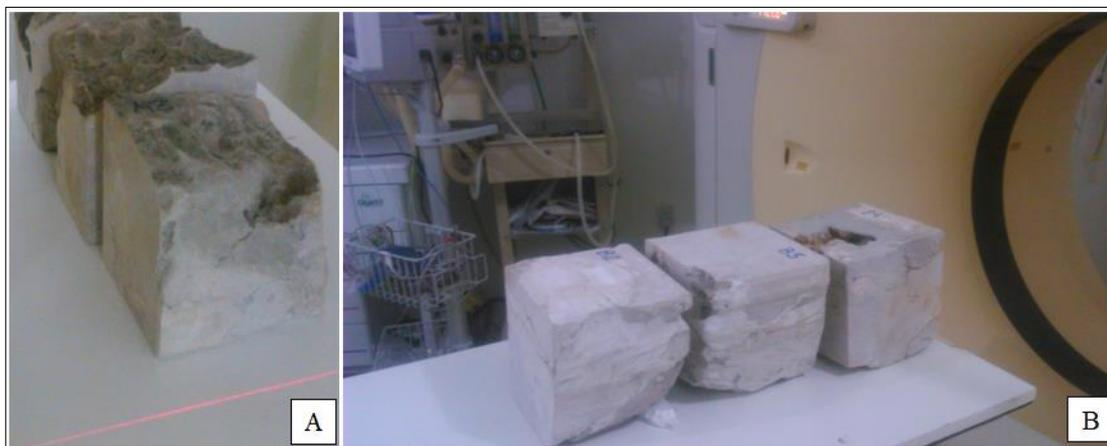
Figura 3.13– (A) Amostras de topo, indicando pela linha vermelha o final do procedimento. (B), Início do processo com a mesa avançando em direção ao *Gantry*.
