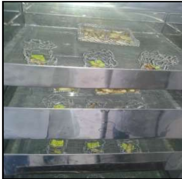
Figura 3.7 - Fatias de berinjelas sobre bandejas e em estufa com circulação de ar
