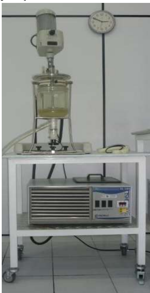
Figura 5. 2 - Unidade experimental para produção de biodiesel
