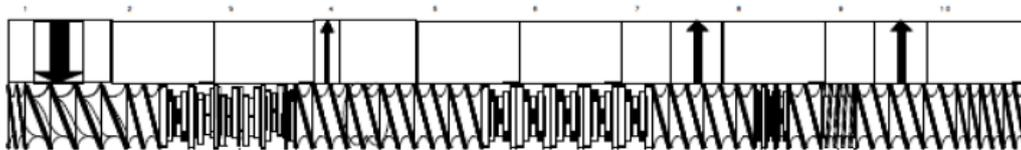
Figura 5- Configuração da rosca da extrusora contendo elementos dispersivos e distributivos.
