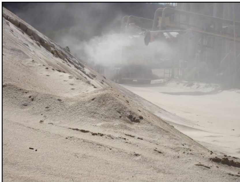
Figura 7 – Armazenamento irregular do sienito processado.
