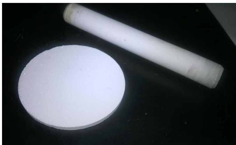
Figura 12 – Imagens das membranas confeccionadas na geometria de discos planos e na geometria de tubos.
