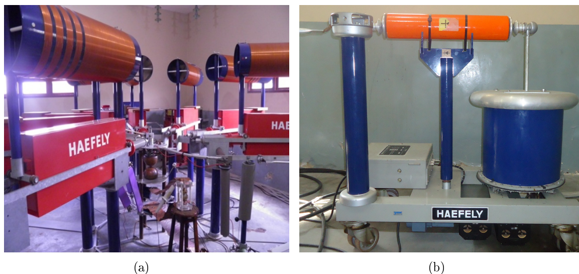
Figura 4.6 – Fotografia do gerador de impulso de corrente do LAT-UFCG. (a) Capacitores, indutores, resistores, centelhador. (b) Transformador elevador de tensão e diodo retificador.
