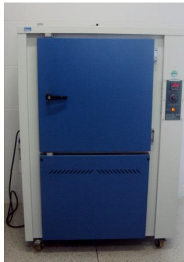
Figura 3.30: Estufa utilizada na secagem convectiva das amostras de maçã.
