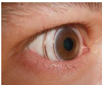
Figura 6 – Lentes de contato escleral/sensor indutivo.
