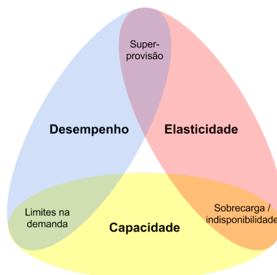
Figura 1.1: Triângulo da gerência de recursos da nuvem. Provedores podem priorizar apenas dois dos três eixos do triângulo ao oferecer um serviço na nuvem.
