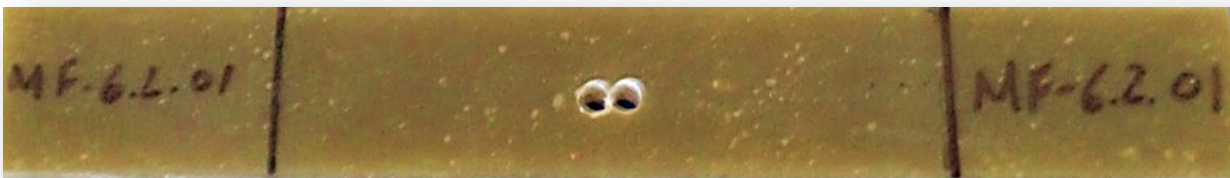
Figura 22 – Corpos de prova com variação do espaçamento entre os furos. (a) 6,2mm de distância entre raios, (b) 12mm de distância entre raios, (c) 48mm de distância entre raios.
