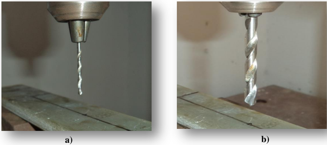
Figura 24 – Brocas helicoidais de aço rápido. (a) broca de 2 mm de diâmetro, (b) broca de 6 mm de diâmetro.
