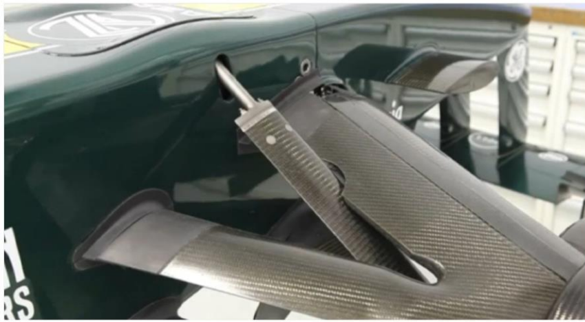
Figura 2 – Suspensão de um Fórmula 1 feita com fibra de carbono.
