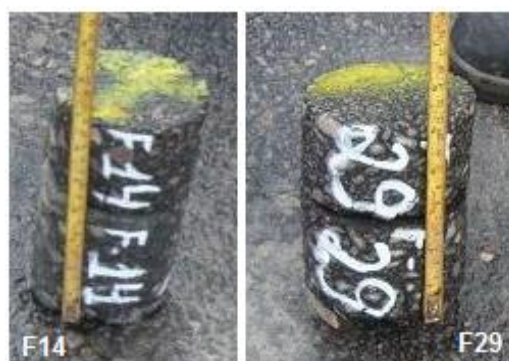
Figura 44 - Exemplos de corpos de provas que não apresentaram aderência na interface.
