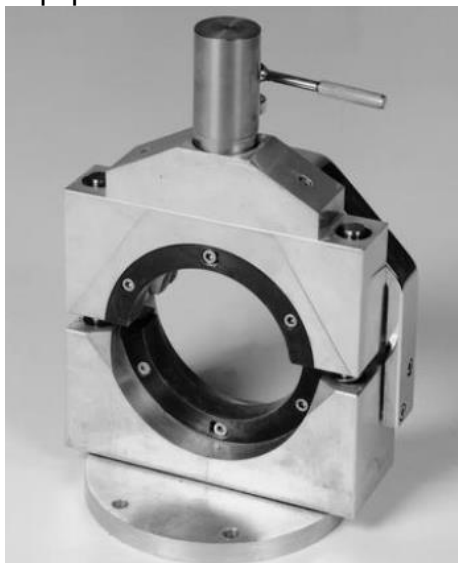
Figura 10 – Equipamento do ensaio Leutner Shear Test .
