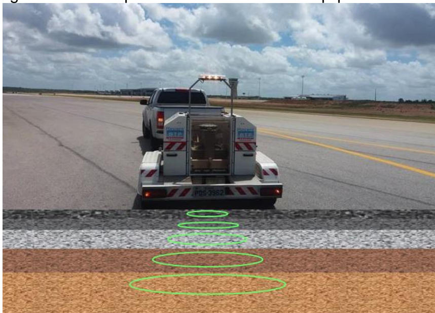
Figura 30 – Princípio de funcionamento do equipamento FWD.
