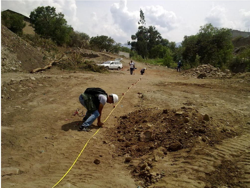
GRAFICO N° 37: Colocación de los geófonos en una distancia de 25m a cada lado del punto de interés.
