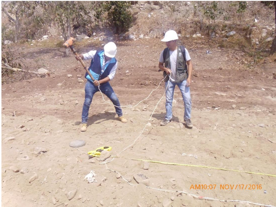
GRAFICO N° 39: Impacto con el martillo al disco de metal, con la intención de provocar ondas.
