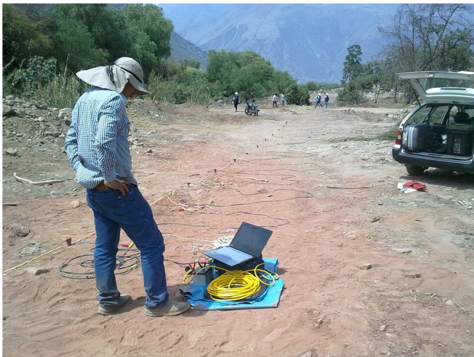
GRAFICO N° 40: Equipo que recibe las ondas emitidas al suelo.
