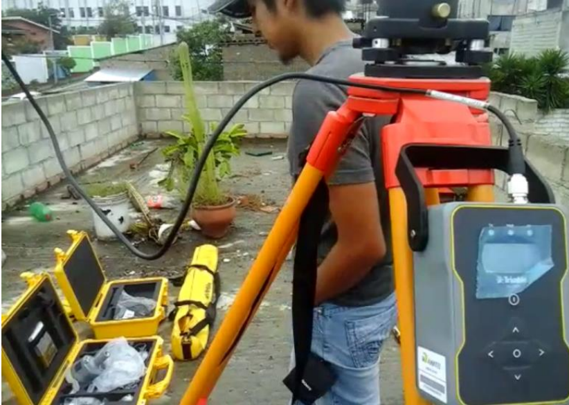
FIGURA N°08: Verificación de los implementos del Equipo RTK R10 en el primer día del Trabajo de Campo.
