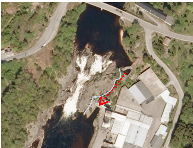
Figur 2. Boenfossen med kraftverksgate (rød pil) og laksetrapp (lys blå strek) (Norge i bilder).
