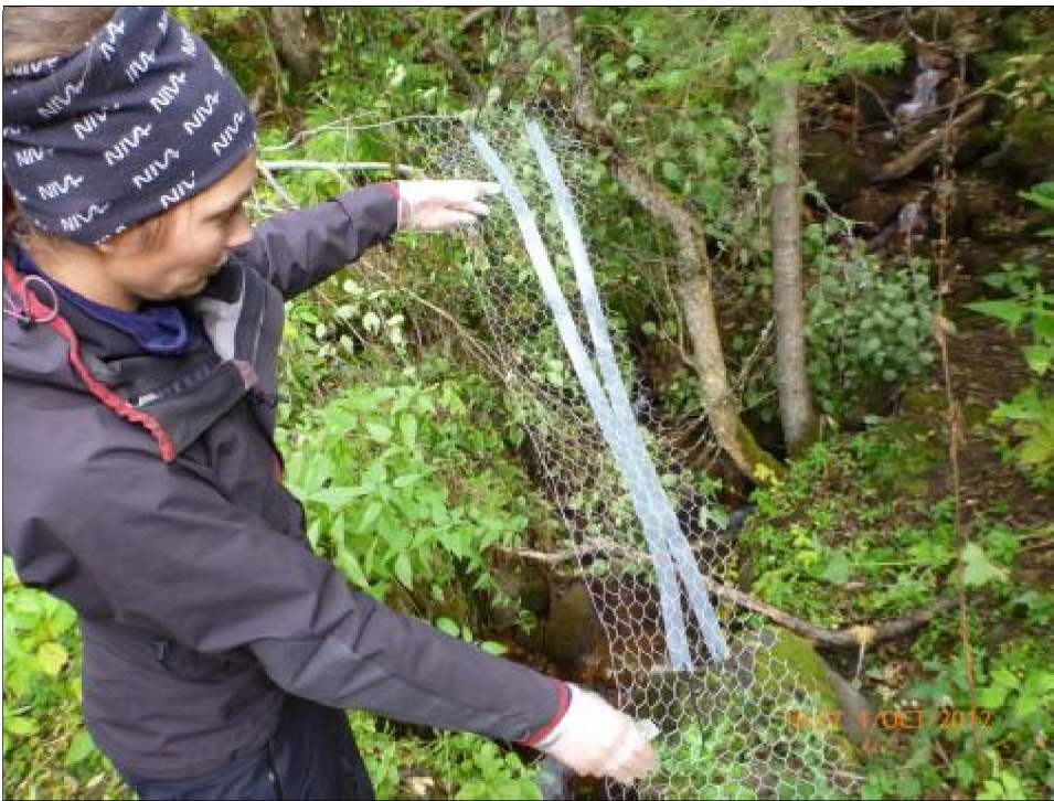
Figur 1: Montering av passive prøvetakere på hønsenetting (foto: Morten André Bergan).
