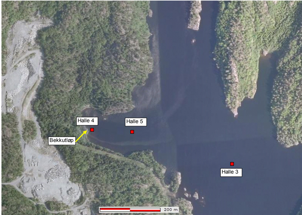
Figur 124. Stasjoner benyttet for å vurdere eventuell spredning av steinbruddsforurensninger via Kryssgårdssæterbekken; gradientstudium av turbiditet.
