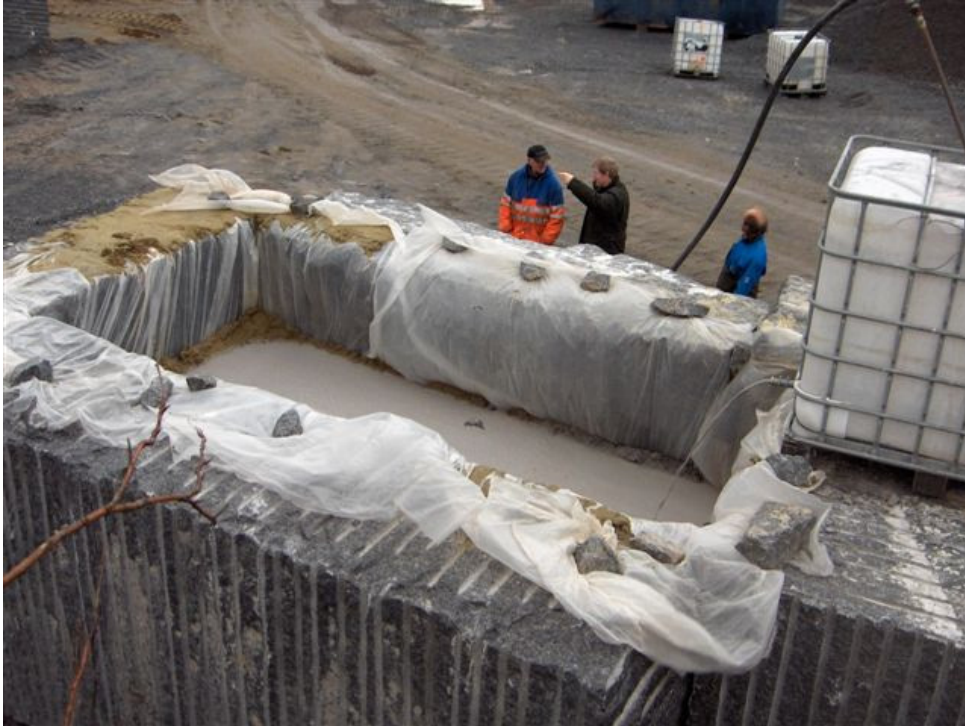
Figur 139. Forsøk med filtrering gjennom steinullrester (avfall fra steinull produksjonen)
