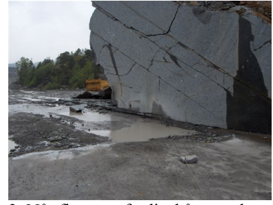
3. Når flaten er ferdigskåret er det dannet mye slamvann
