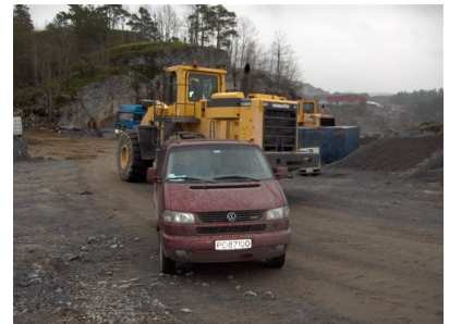
9. Oppfylte masser trafikkeres av maskiner på mer enn 50 tonn, noe som bidrar til knusing av mer stein
