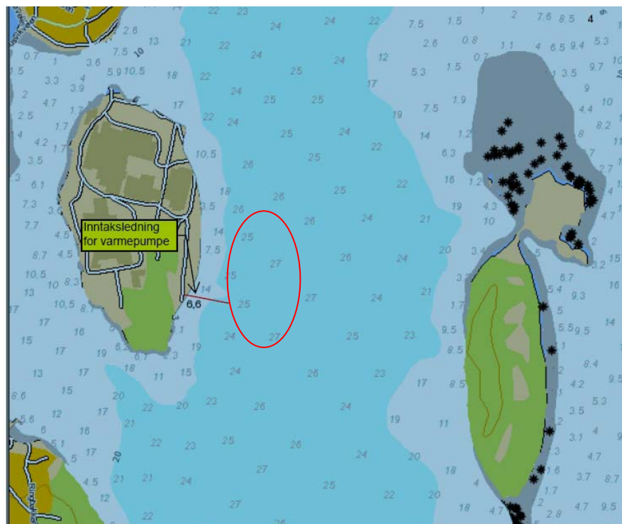
Figur 1. Jarlsø med posisjon for inntaksledning for varmepumpe. Observasjonen ble tatt på ca. 26 meters dyp i området merket med rød oval.
