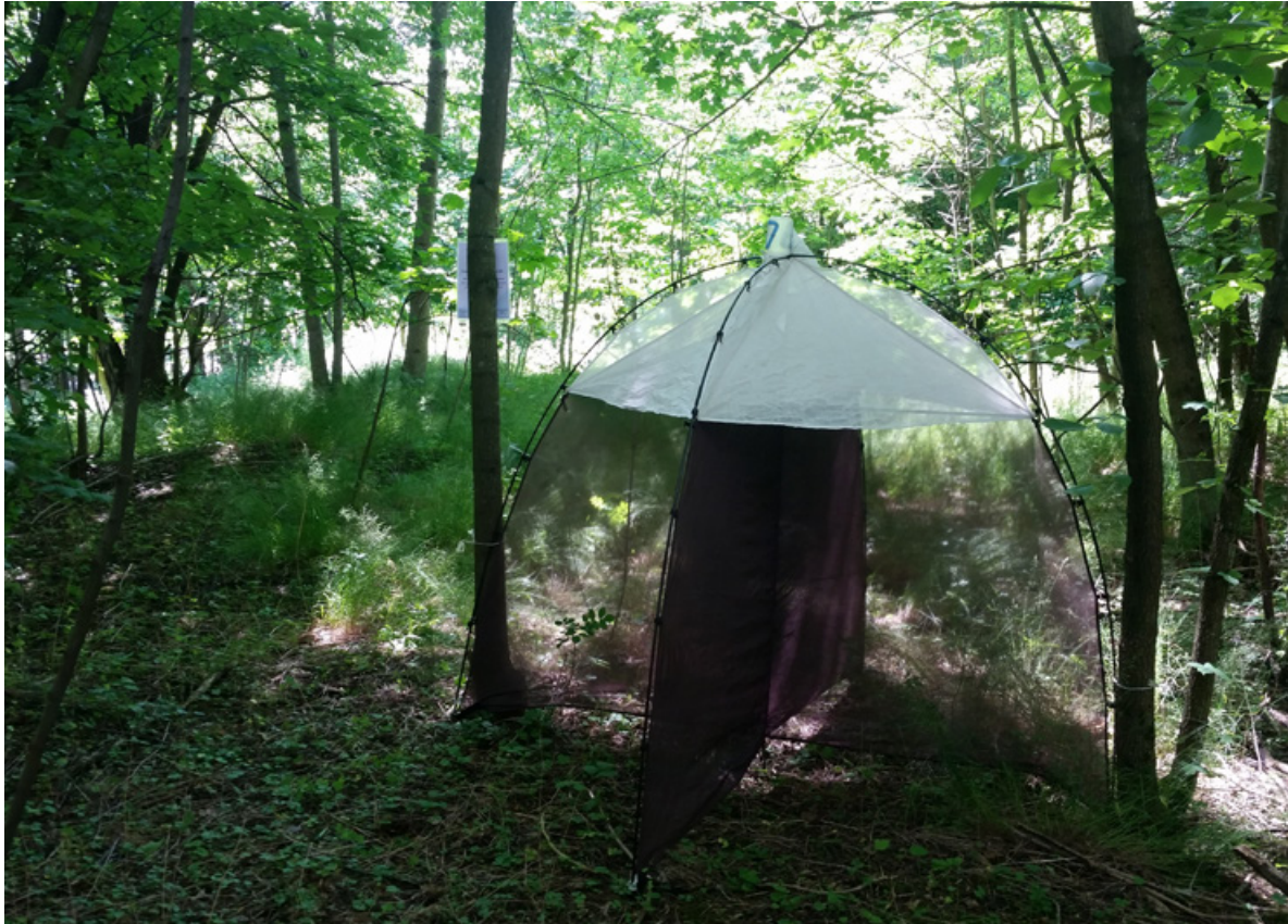
Figur 6. Malaisefelle («slam trap») utplassert på Clausåsen (32VNM9409342525) på Bygdøy i Oslo kommune i 2016. Foto: Anders Endrestøl.
