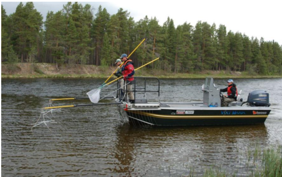
Bilde 1. Under det elektriske båtfisket ble det benyttet en 18 fots aluminiumsbåt med en 200 hestekrefters utenbordsmotor med vannjet. Illustrasjonsbildet er fra en tilsvarende undersøkelse i Rena. Foto: Jon Museth.
