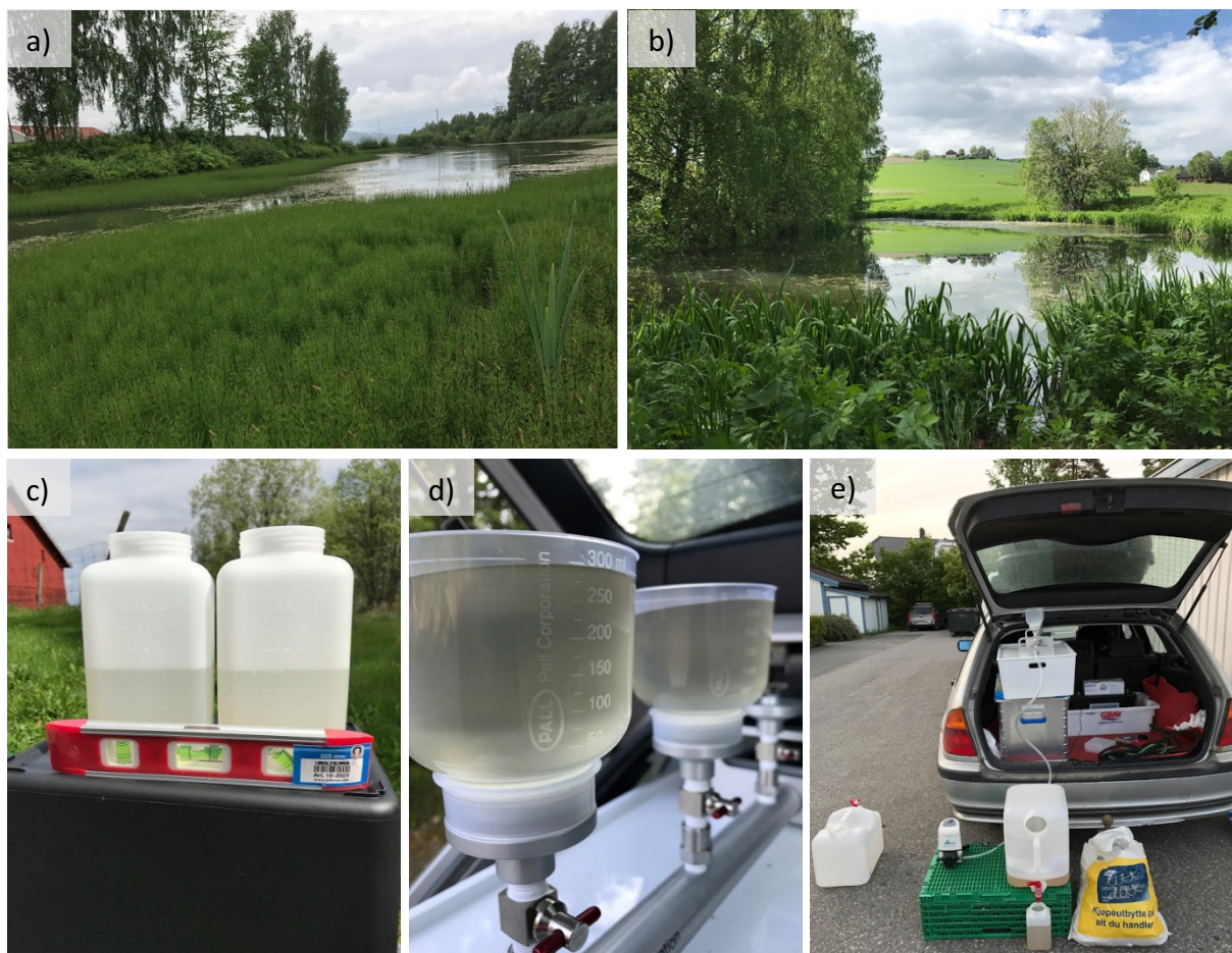
Figur 2.4 Bilder fra feltarbeid. a) Lahelldammen, b) Vivelstad, c) replikate vannprøver fra samme oppsamlingskanne, d) illustrerer målefeil ved oppmåling, e) oppsett i bil med oppsamlingskanne i forkant av bilen, manifoil og filter på hvit kasse med utløpslange drevet av et bilbatteri.
