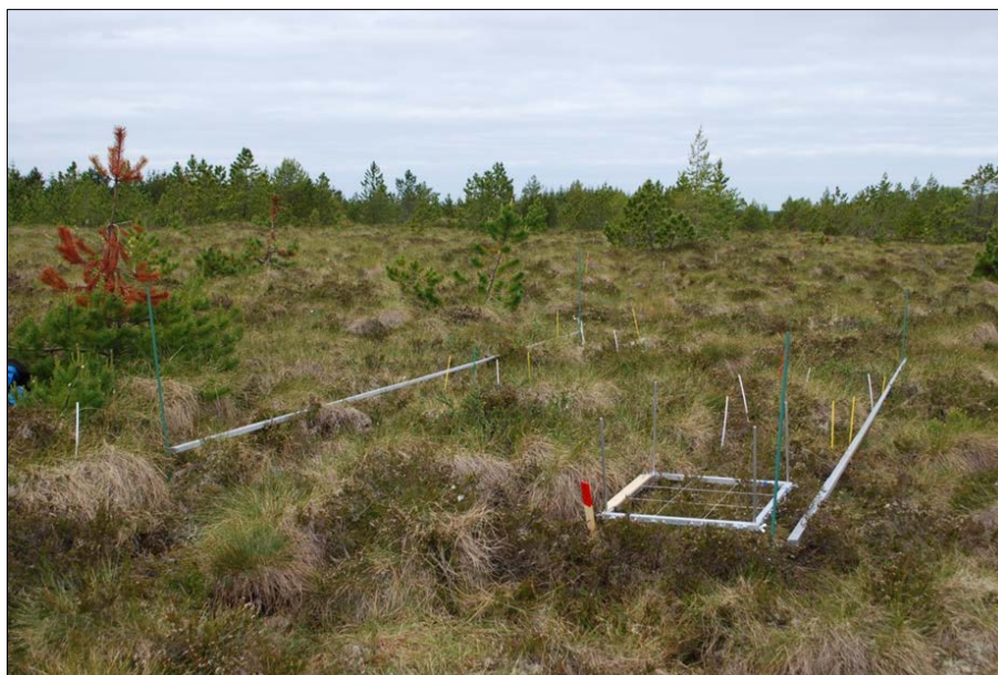
Figur 4. Utlegging av analysefelt i tuemyr på Aukra i 2010 med fem analyseruter. Analyseramme av aluminium delt i 9 småruter.
