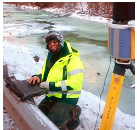
Figur 6.3. PhD-stipendiat Netra Timalsina på feltoppdrag ved en vinterlig Sokna. Her ble det samlet inn data om isforhold og klima gjennom flere felt-sesonger. Bildet viser en situasjon med bunnis der vannet strømmer oppe på isen og er svært eksponert for frost, noe som fører til videre oppbygging av is i elveløpet.
