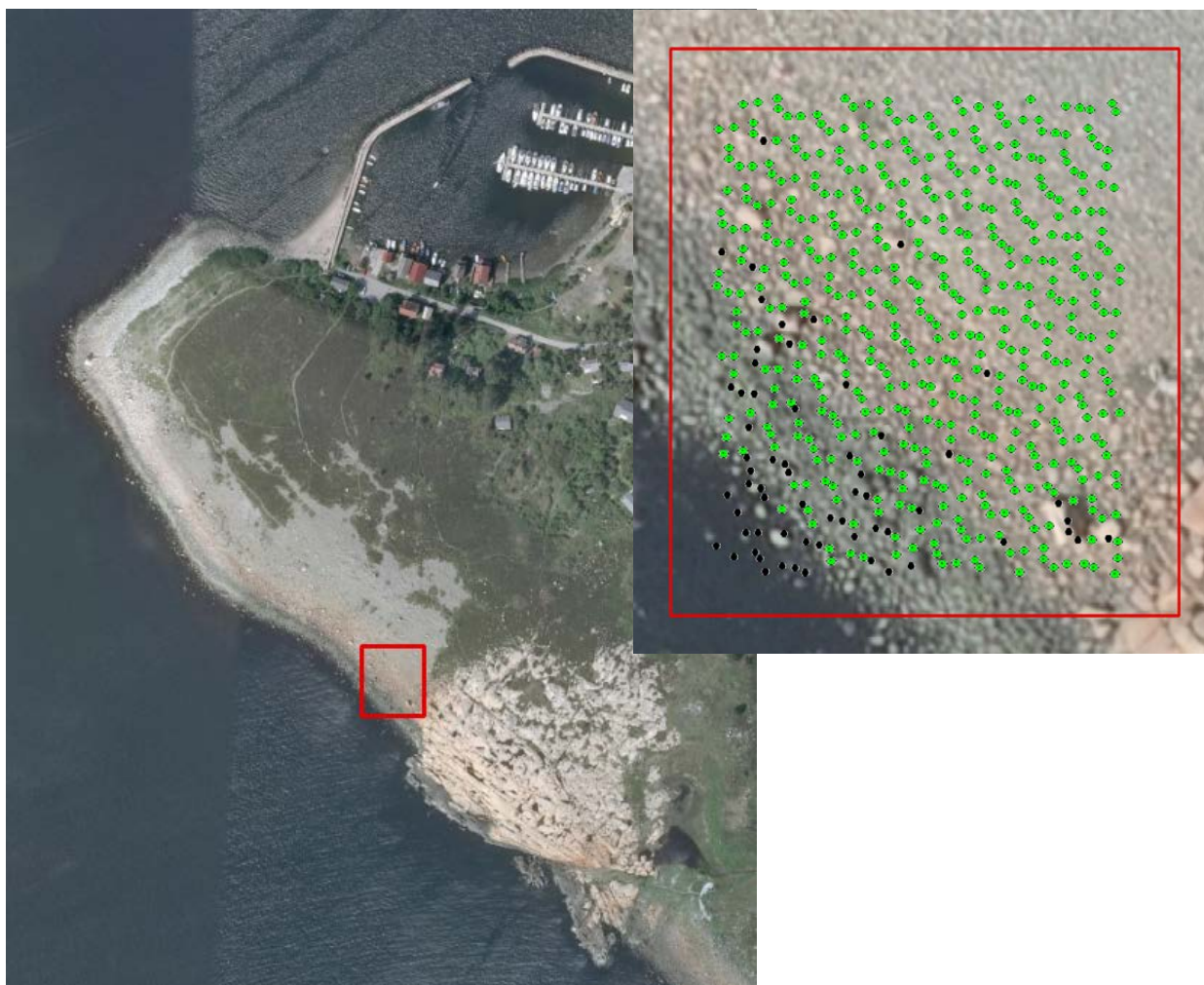
Figur 10. Lidar avlesningspunkter innenfor et område på 30 x 30 meter på en strand ved Brattestø på Hvaler i Østfold. Svarte punkter er punkter som oppfattes av programvaren som uteliggere og som ikke teller med. Legg merke til at flere av disse er reelle verdier fra toppen av steiner. Legg også merke til at det finnes områder på stranda med punktavstand opp til 2-3 meter. Modellen kan sammenlignes med en modell med høyere oppløsning i vedlegget.
