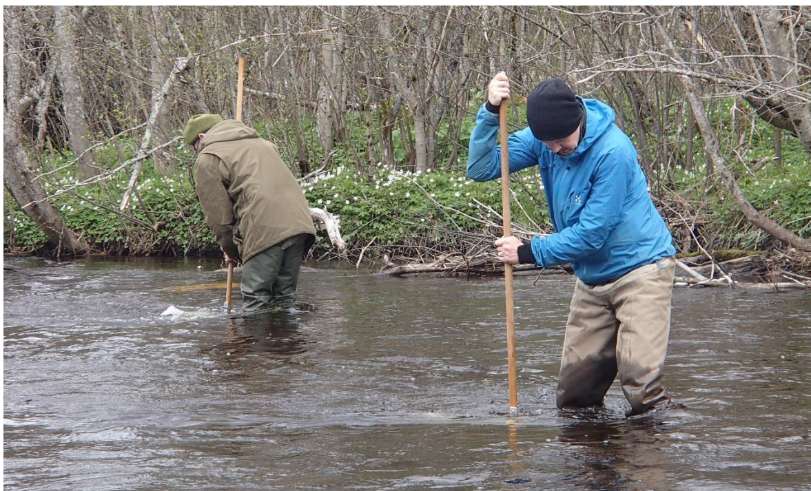
Figur 9. To ulike måter å bevege seg foran sparkehåven, ryggende oppstrøms og spark fra siden. Foto: Knut Andreas E. Bækkelie, NINA.
