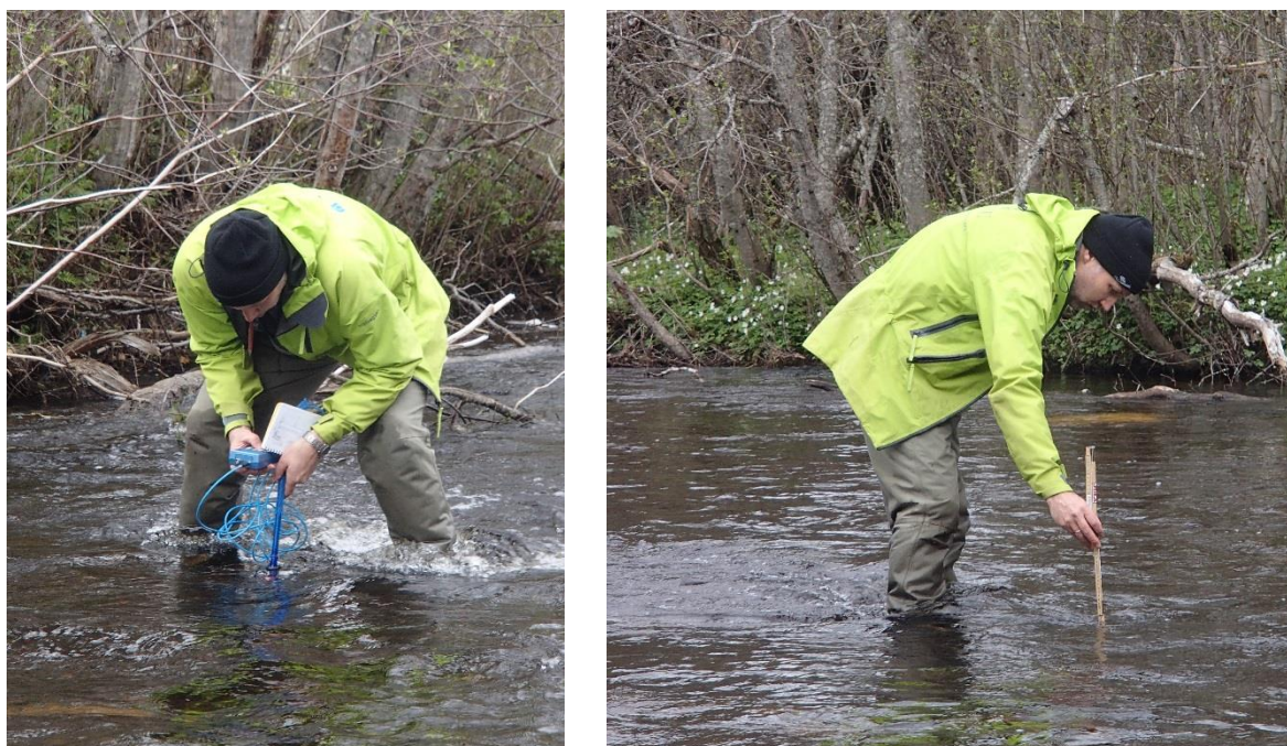
Figur 10. Måling av strømhastighet og dybde. Foto: Knut Andreas E. Bækkelie, NINA.
