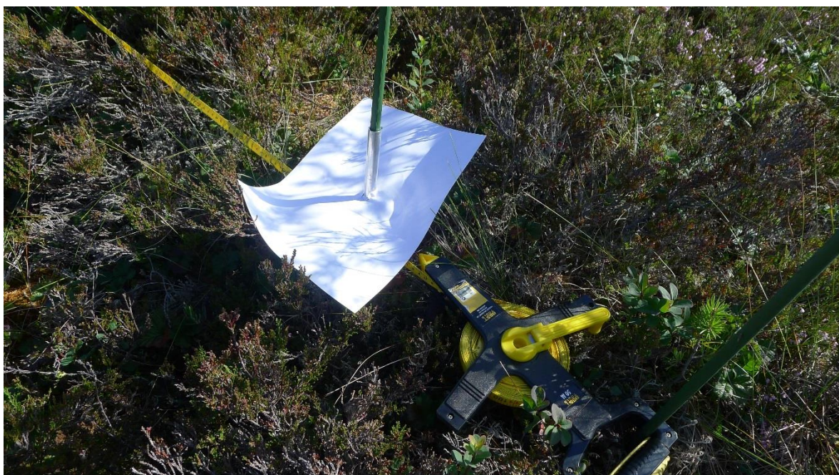
Figur 8. Endepunktene på alle transektene ble målt inn med differensial-GPS. Det ble lagt hvite ark på punktene, som synes fra dronefotoene. Disse punktene benyttes som supplement for å georeferere bildene.
