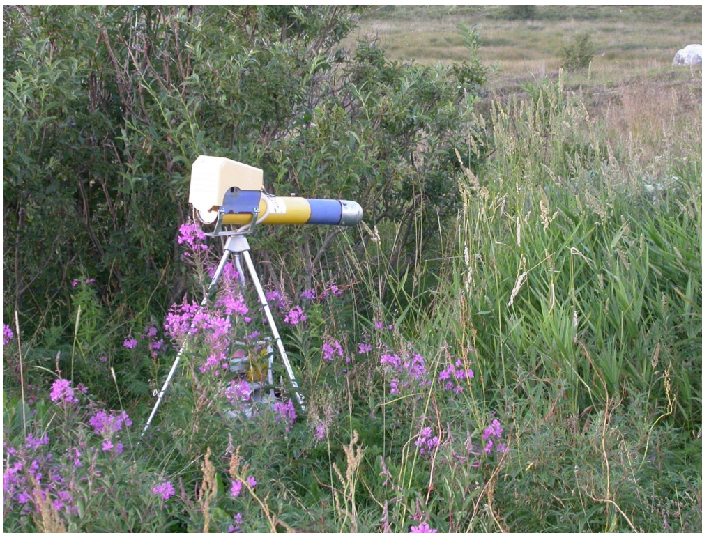
Figur 5. Gasskanon brukes hyppig for å skremme fugler fra områder de er uønsket, eksempelvis gjess fra beitemark eller fugler ved flyplasser. Foto: Arne Follestad.
