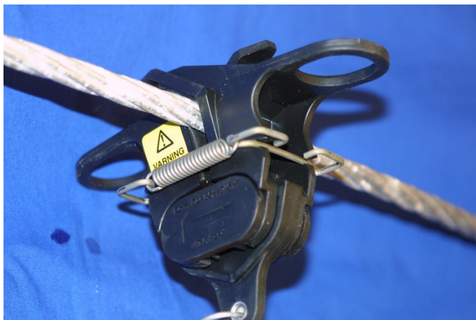
Figur 4. Resultatene av akselererte korrosjonsforsøk med festeklemmer for plasturo, som ble montert på linene, viste ingen spesielle tegn til korrosjon på linene under klemmene (Foto: S. Refsnæs).
