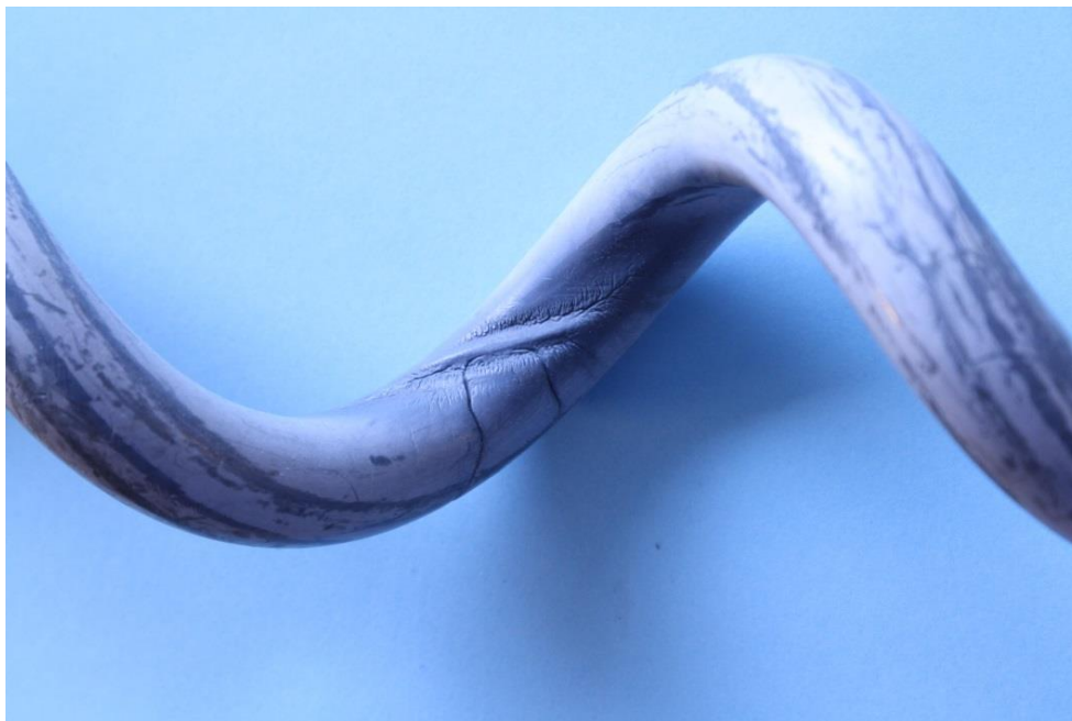
Figur 3. Eksempel på krakelering og slitasje som har oppstått på dempespiralen i kontaktflaten mot linene (Foto: S. Refsnæs).
