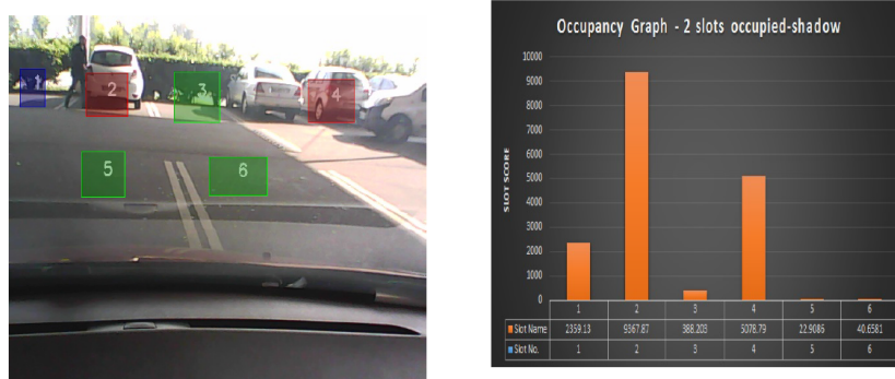
FIG. 3 – Effet d’ombre sur un emplacement de stationnement. Le stationnement d’un véhicule a produit une ombre sur un emplacement adjacent causant alors une mauvaise détection (partie gauche). Histogramme des scores (stratégie 1) associés à chaque emplacement (partie droite).
