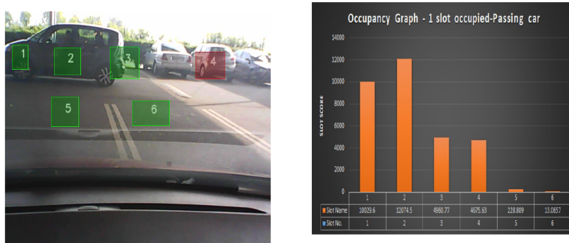
FIG. 2 – Étude de la robustesse de notre système face aux objets dynamiques occultants. Scène de parking avec un véhicule occultant des emplacements de stationnement (partie gauche). Histogramme des scores (stratégie 1) associés à chaque emplacement (partie droite).
