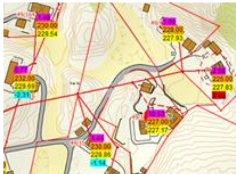
Figur 4: Presentasjon av avvik mellom beregnede og målte spenninger i NIS ved bruk av AMS data.
