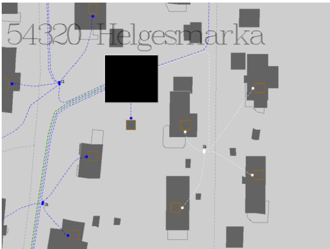
Figur 9: Resultatet fra avspørring av AMS-målere: nettet under lavspenningslisten er spenningsløst (vist med hvit markering).
