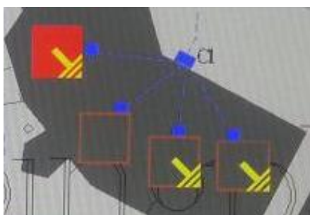
Figur 3: Presentasjon av målere i ett større bygg med fasebrudd og jordfeil i DMS.
