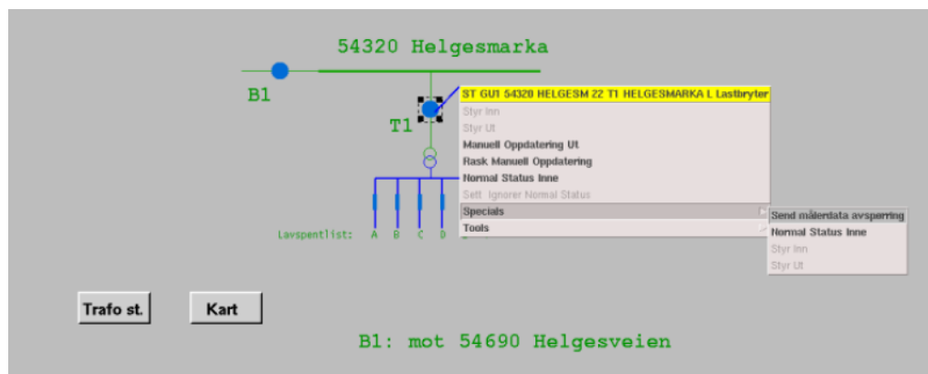
Figur 8: Avspørring av AMS-målere under en lavspenningstlist.
