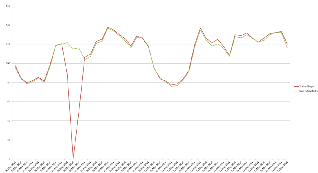
Figur 11: Sammenligning av energimåling i trafo og summen av målt forbruk i tilhørende trafokrets.
