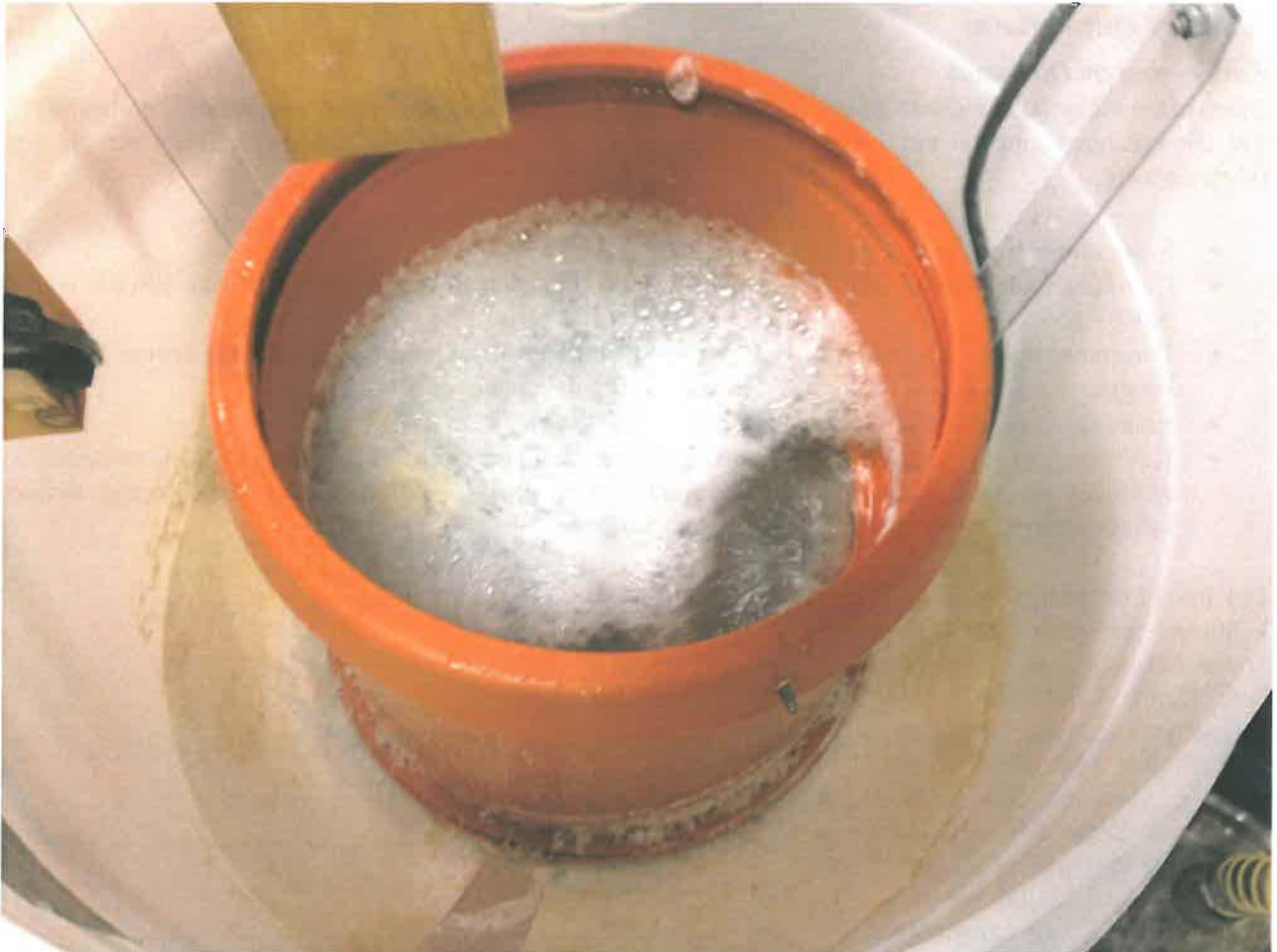
Figur 21 viser hvordan laken strømmer ujevnt.
