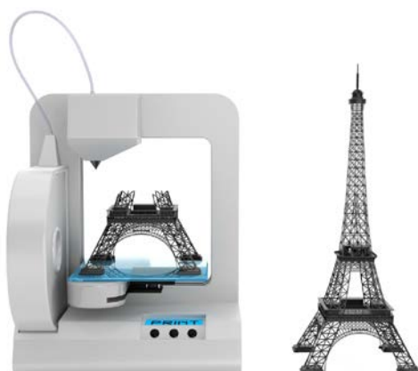
Figur 9. Med 3D-printing bygger man opp et produkt lagvis fra bunnen av.
