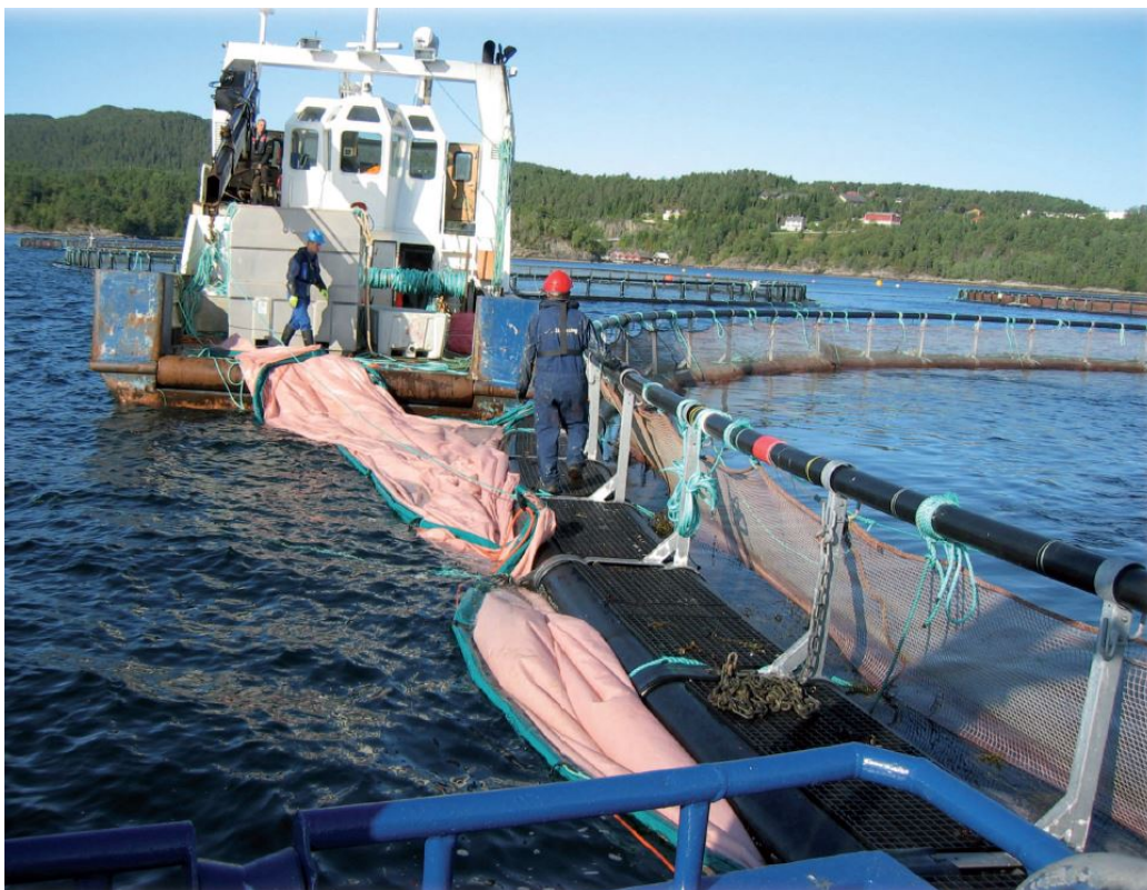
Figur 7: Bilde av arbeidsbåt som her brukes for å sette ut heldukspresenning ( Foto: Fiskeridirektoratet)
