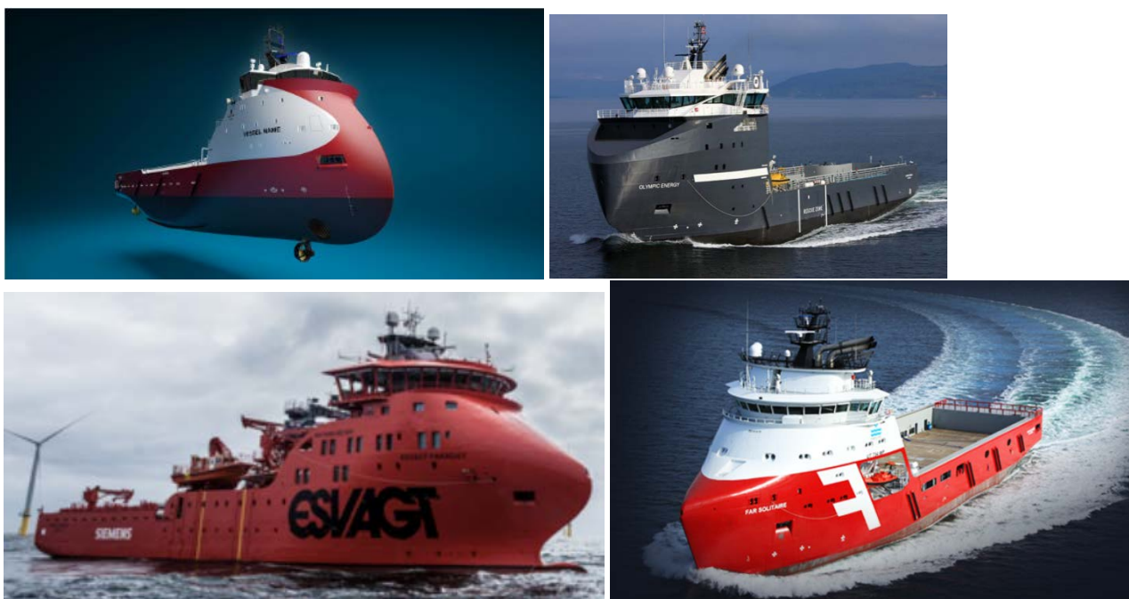
Figur 4-5 Eksempler på skrogløsninger utviklet i klyngen for effektiv gange i bølger
