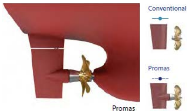
Figur 4-12 Rolls-Royce Promas system (Illustrasjon: Rolls-Royce)
