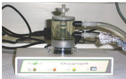
Figur 3-1: Oksygraf - måling av nedgang i oppløst oksygen ved bruk av en polarografisk elektrode
