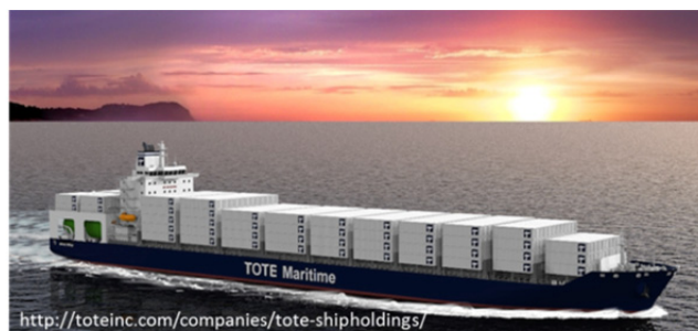
Figur 37: Verdens første containerskip med LNG og høytrykks "langsomtløpende totakts dual-fuel" motor
