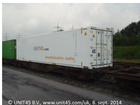
Figur 28: 45 fots diesel-elektrisk container
