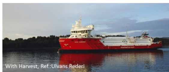
Figur 32: With Harvest, gassdreven bulkbåt spesialbygd for frakt av fiskefôr
