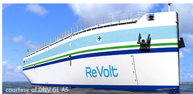
Figur 25: ReVolt batteridrevet godsskip for nærskipfart
