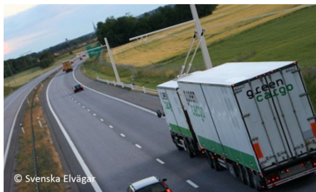
Figur 27: Bildemontasje med luftledning for eldrift av tunge kjøretøy i hovedvegnettet
