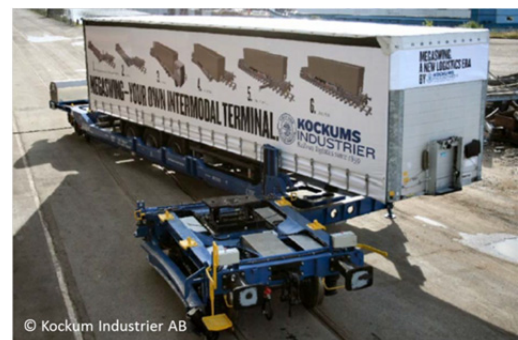
Figur 45: Megaswing for horisontal lasting/lossing av containere og hengere på tog
