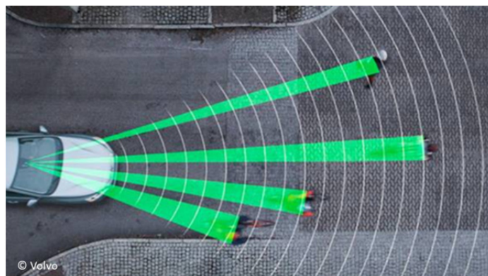
Figur 23: Flere av dagens automatiske bremsesystemer er konstruert for å reagere på dyr og mennesker i veibanen.
