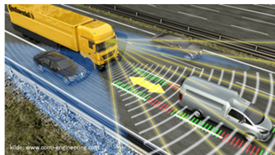
Figur 8: Eksempel på ITS-applikasjon: Adaptiv cruisekontroll
