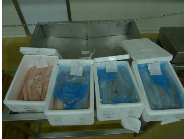
Bilde 3 De samme kassene som i Bilde 2, men med lokket av. Da jeg regnet med at det kom flere kasser, lagde jeg 6 merkelapper. Valgte å bruke numrene 1, 2 4 og 6 slik det framkommer på bildet. Kasse nr 6 inneholder hyseloins som skulle til Matis. Kassen inneholder 1 templogger. Vi ser også en templogger i kasse 2. I kasse nr 1 og 2 var all isen i blå pose smeltet. I kasse nr 4 var den delvis smeltet
