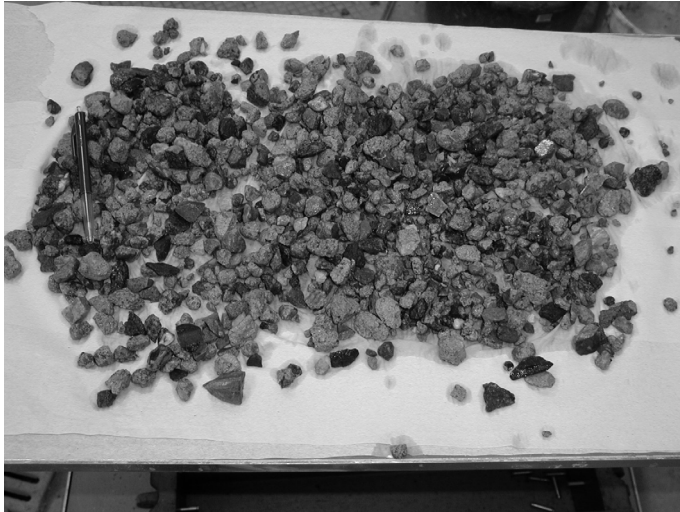
Figur 6-1. Måling av vannabsorpsjon av resirkulert tilslag (Foto: Bente Lillestøl, Veidekke ASA)
