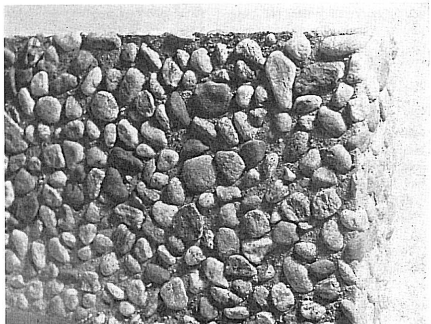
Fig. 6. Nærbilde av overflate med retarder Y i fig. 5. Close-up of surface with retarder Y in Fig. 5.
