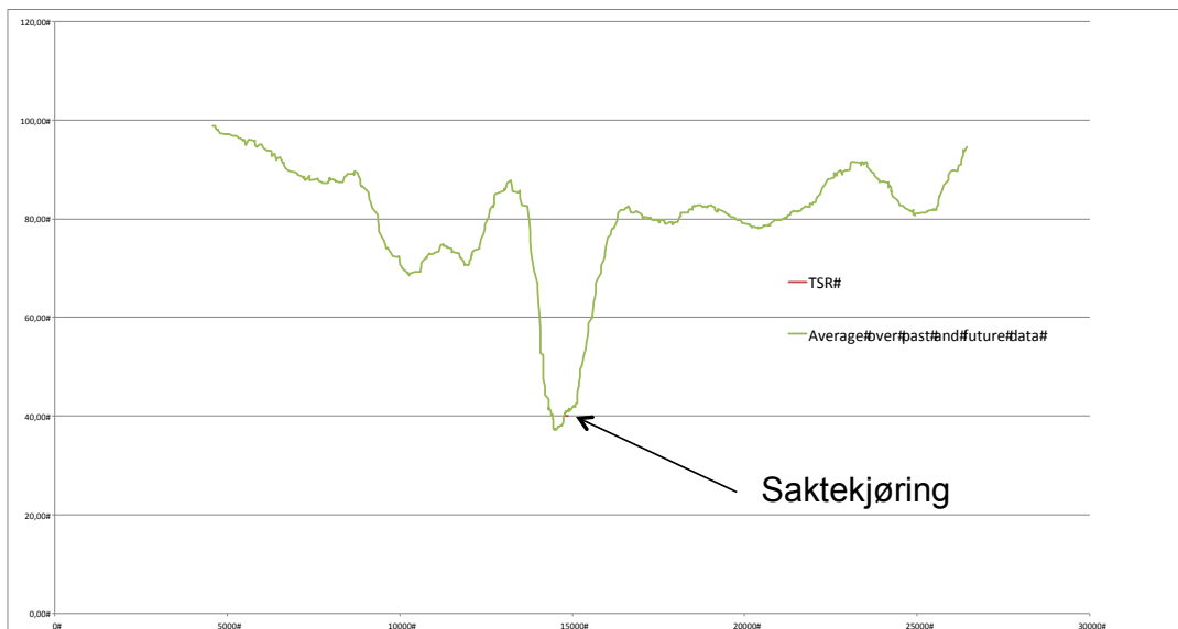
Figur 81. GPS-støttet analyse av effekten av en saktekjøring. Her vises flytende gjennomsnitt.
