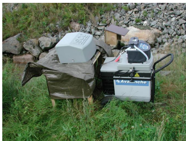
Målestasjon (ISCO) i Heiabekken (Foto: G. Tveiti).
