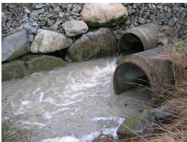
Målerør i Heiabekken. Vannføring beregnes på bakgrunn av vannhøyde og kjent vannføringsformel for røret (Foto: A. Pengerud).
