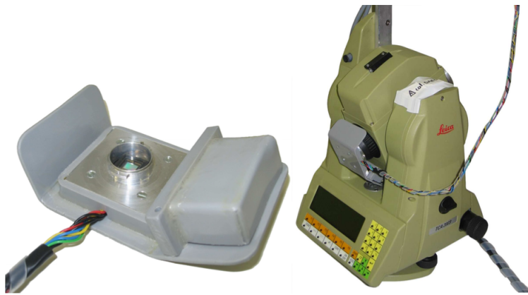
Figur 6.8: Totalstasjon med Daedalus montert. [Guillaume et al., 2012]
