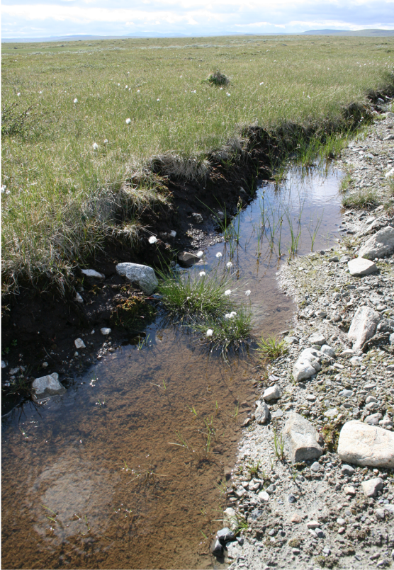
Figur 4-25: Det er mindre tilvekst jo brattere helningsvinkel en grøften har uavhengig av vegetasjonstype og jordtype.
