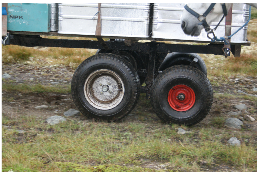
Figur 2-3: Vogna har også fire hjul bak. Totalt åtte hjul gjør at trykket mot bakken ikke blir så stort.
