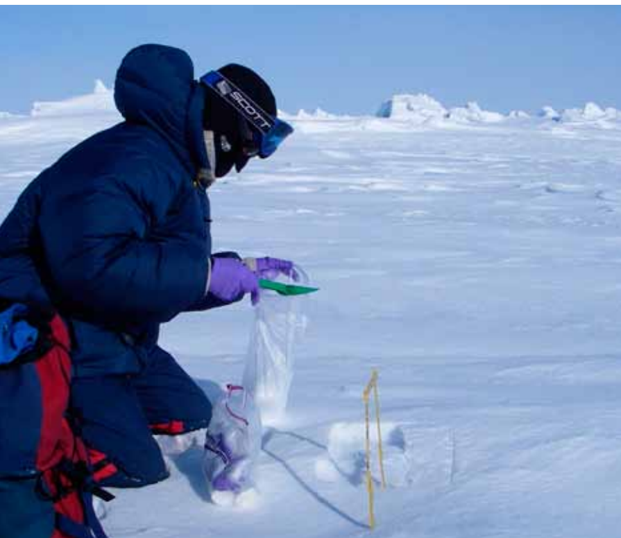
SNØMÅLINGER. Marcel Nicolaus utfører snømålinger under feltarbeid i Arktis. Målingene gir oss data om temperatur, tetthet, fuktighet og struktur av snøen. Foto: F. Latreille
