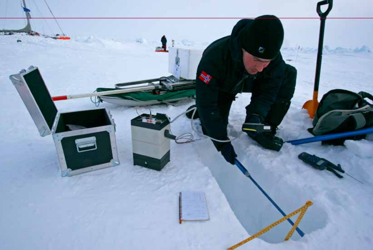
SNØMÅLINGER. Marcel Nicolaus utfører snømålinger under feltarbeid i Arktis. Målingene gir oss data om temperatur, tetthet, fuktighet og struktur av snøen. Foto: F. Latreille
