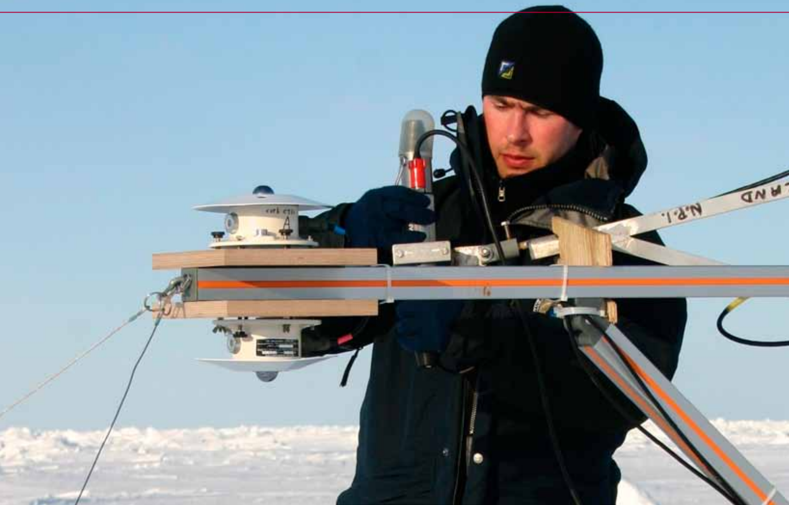
LYSENSORER. Installasjon av lyssensorer på arktisk sjøis i 2007. Foto: Norsk Polarinstittutt
