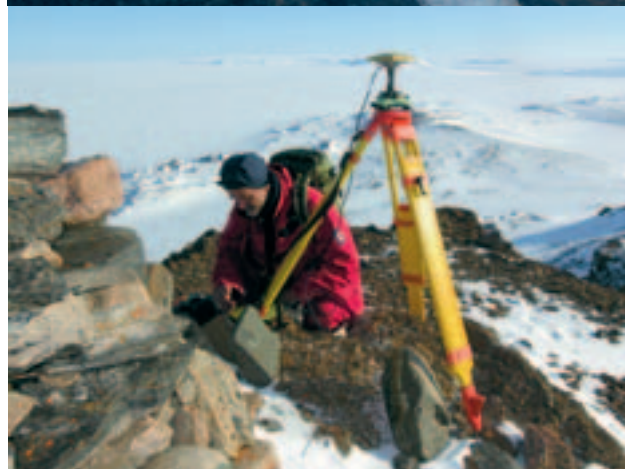
GPS-måling av kjente referansepunkter øker nøyaktigheten for alle GPS-målinger som gjøres på breen.
