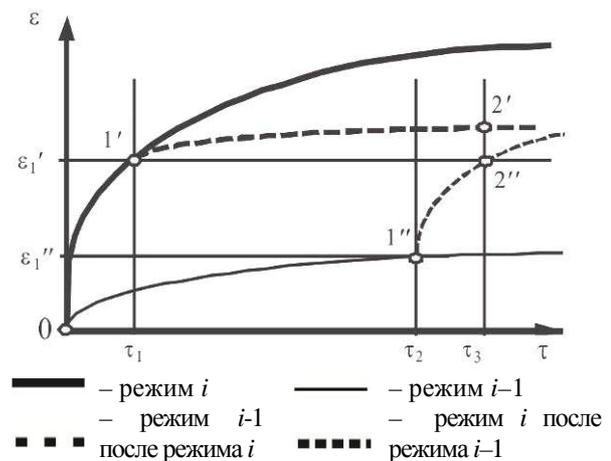
Рисунок 6 – Деформирование материала в условиях ползучести при двурежимном нагружении
