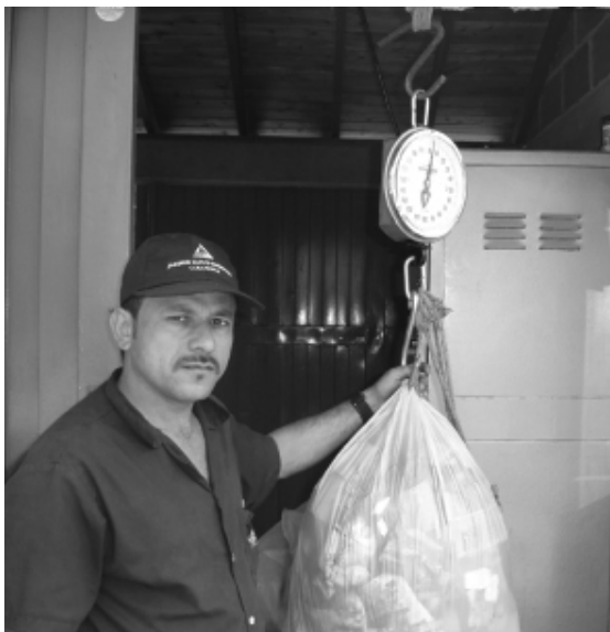
Foto 1. Pesaje de los RS sede Poblado En la foto se observa el operario de servicios generales realizando el pesaje, obsérvese la báscula utilizada de capacidad 200Kg.
