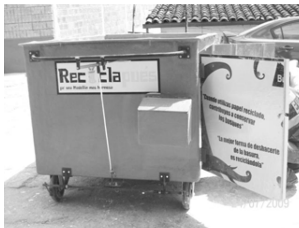
Fig. 10. Prototipo final obtenido después de las pruebas con recicladores y ajustes posteriores.
