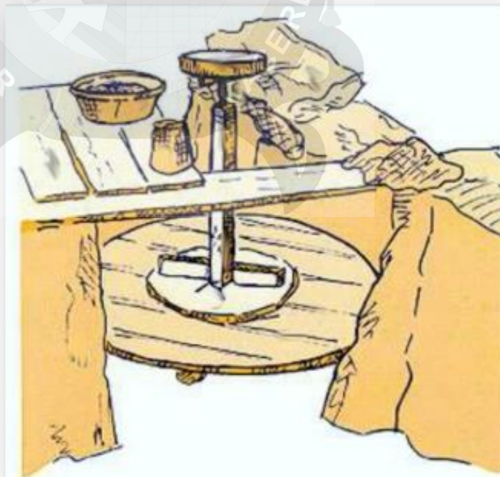
FIGURA 07 Diseño manual del torno empotrado a pared de madera.
